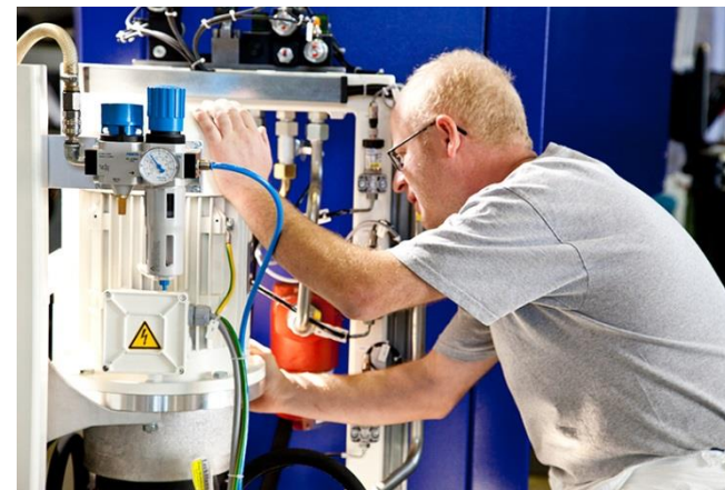
Aufbau eines Hydraulikaggregates
