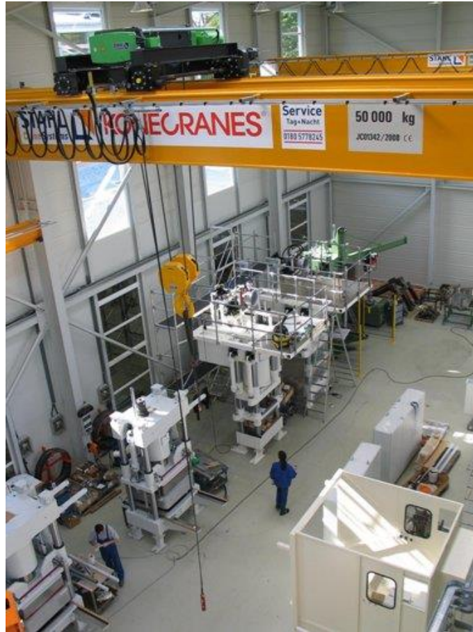
Mechanische Montage, Krankapazität 60 Tonnen, Hakenhöhe 10 Meter
