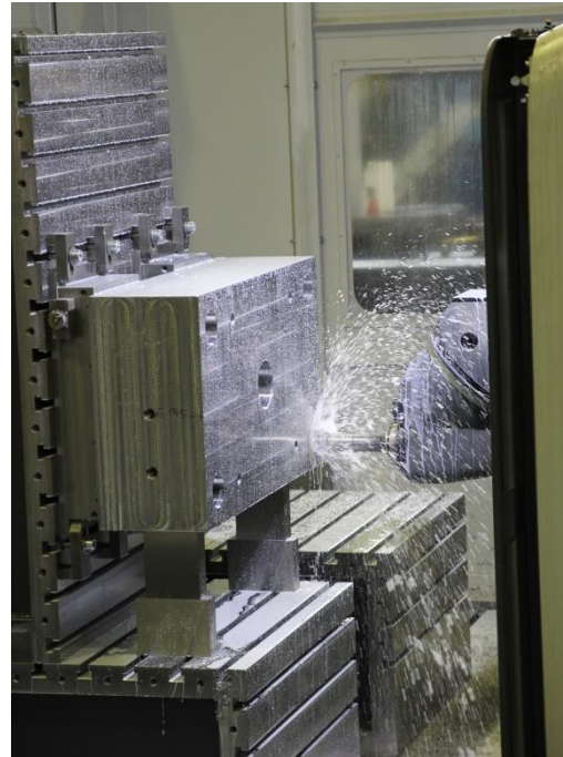
Spanabhebende CNC-Bearbeitung im Haus bis 6 x 2 x 1 m
