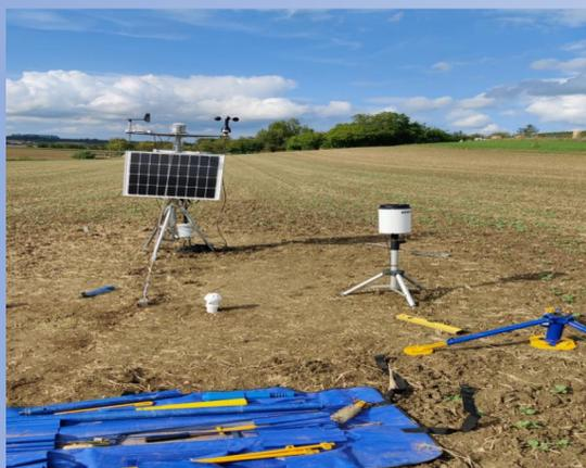
Installation einer Wetterstation und eines Bodensensors auf einer Referenzfläche
