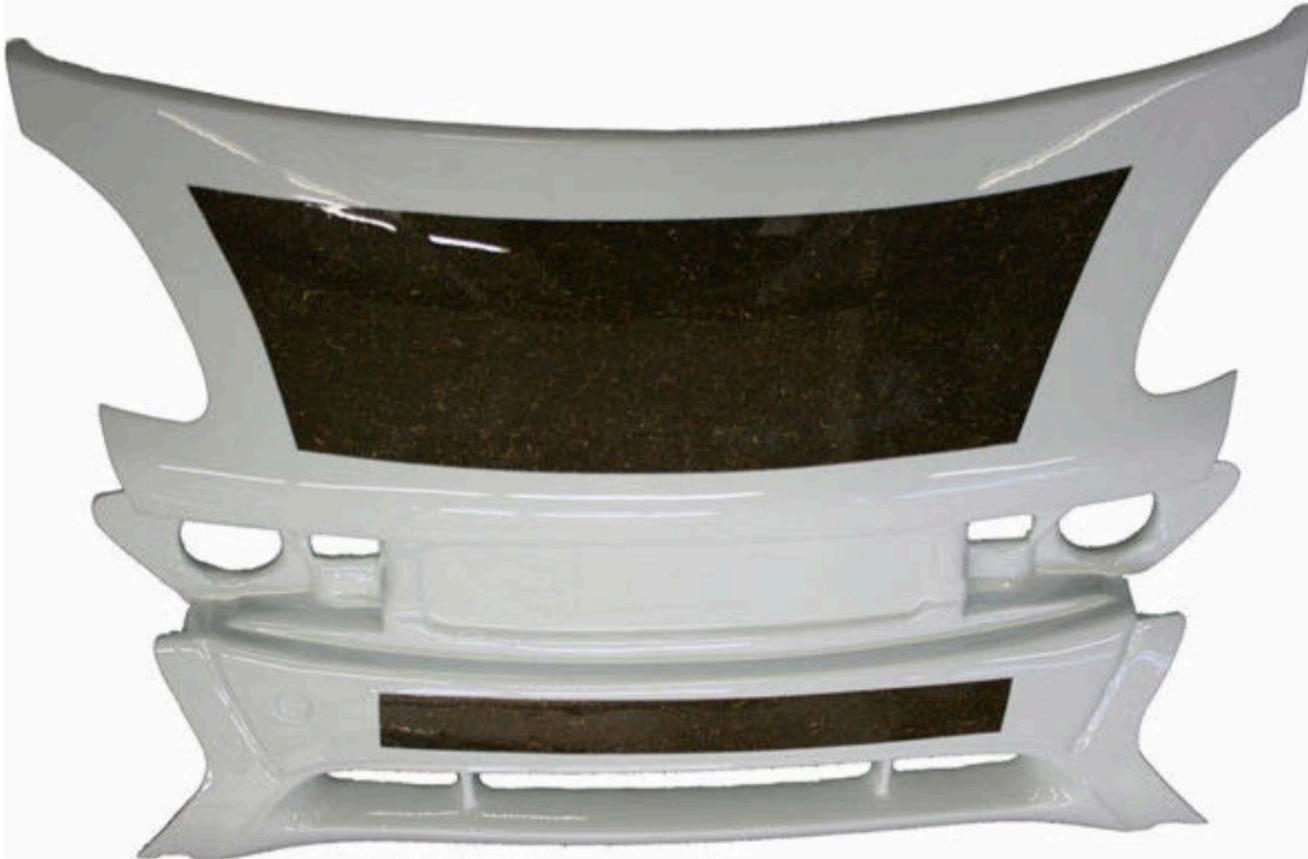
**Bild 333** Fronthaube eines Kleinwagens aus Naturfaser-verstärktem epoxidierten Leinöl. Als Naturfasern kamen Hanf und Flachs zum Einsatz. Bei Fasergehalten von 50 Gewichtsprozent sind biogene Anteile des Formteils von knapp 80 Gewichtsprozent möglich.
