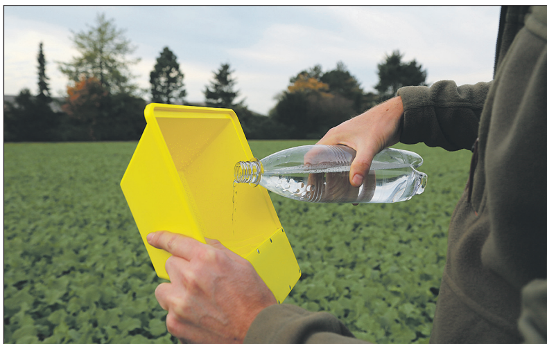
An der Fangschale ist ein seitlich integrierter Vorratsbehälter angebracht, der Wasserverluste durch Wind und Verdunstung automatisch ausgleicht.
