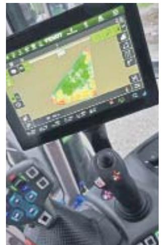
**Das Terminal des Traktors** visualisiert eine Applikationskarte, die auf Basis einer Sensor-Herbstmessung im Raps erstellt wurde.
