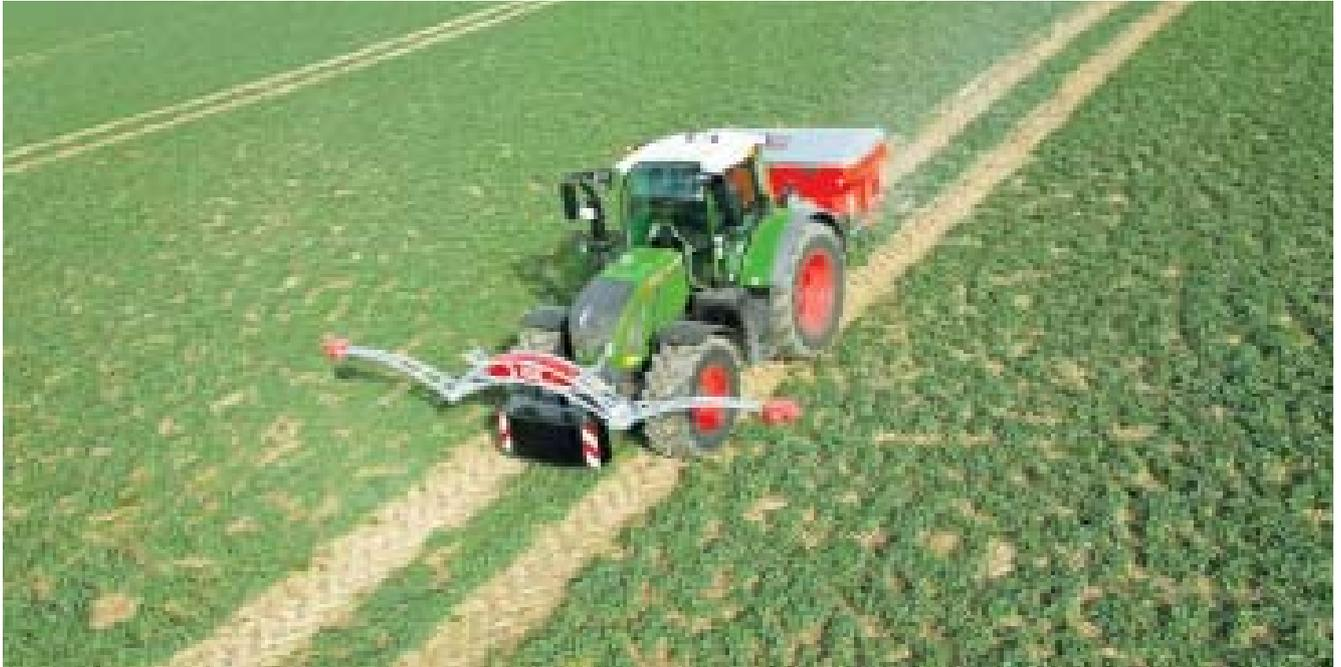
**Das Isaria-System** von Fritzsche im Einsatz zur Applikation von Mineraldünger im Raps. Die Pflanzensensoren werden mittels eines am Fronthubwerk des Traktors befestigten Gestänges senkrecht zum Bestand geführt.
