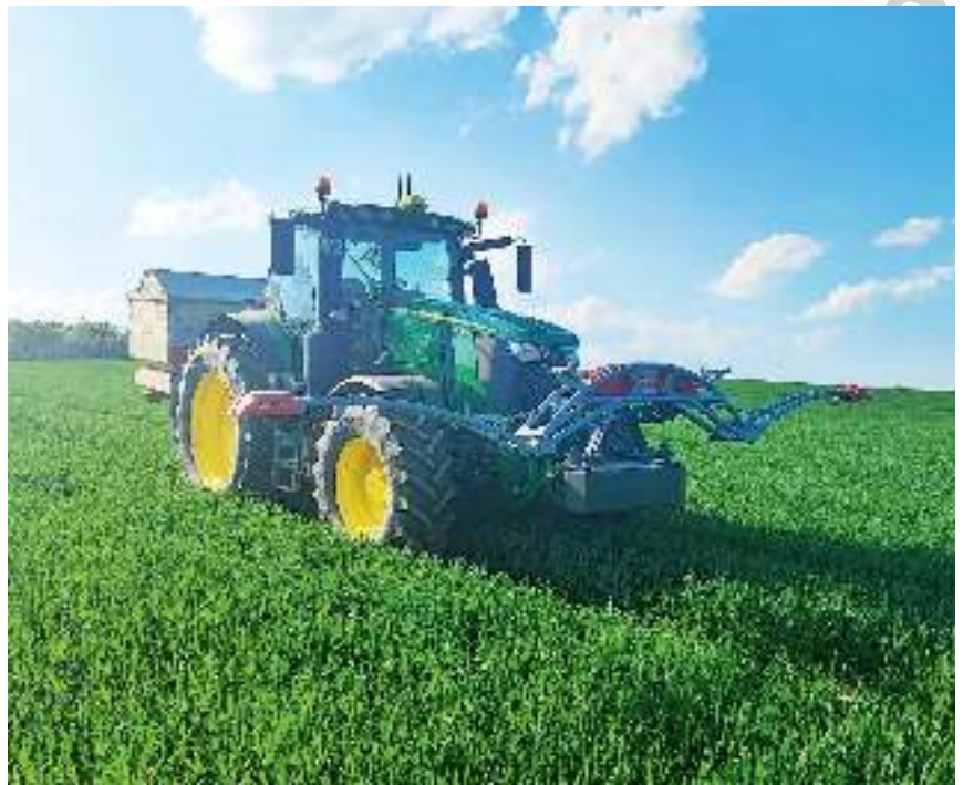
Im Online-Verfahren werden Bestandsdaten direkt bei der Überfahrt gewonnen.
