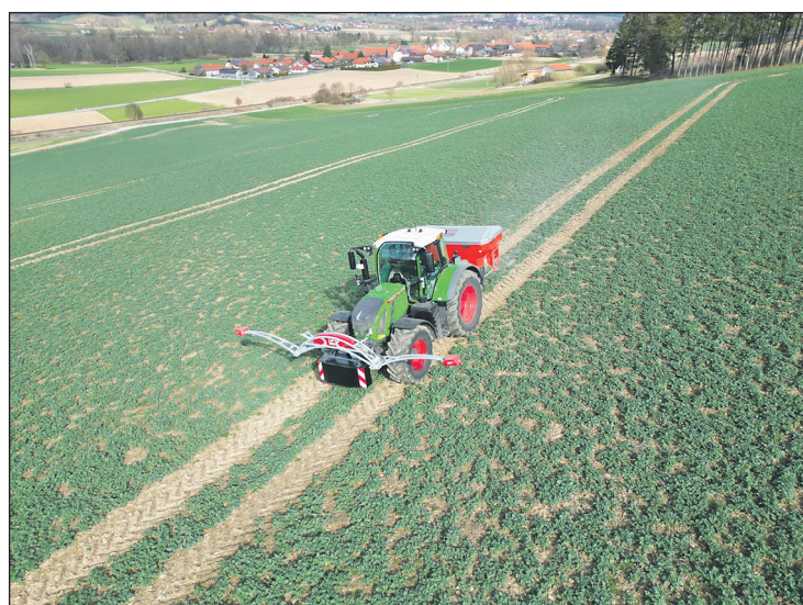
Beim Isaria-System von Fritzmeier werden die Pflanzensensoren mittels einem, am Fronthubwerk des Traktors befestigtem Gestänge senkrecht zum Bestand geführt. Hier im Einsatz zur Applikation von Mineraldünger zur 2. Gabe im Raps. Foto: M. Eichelseder
