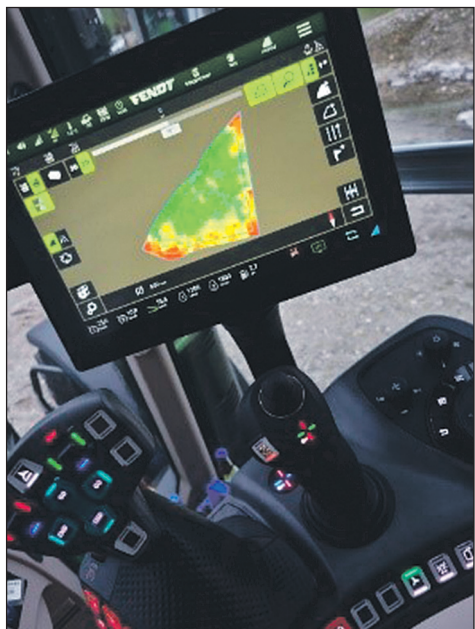
Das Terminal des Traktors visualisiert eine Applikationskarte, die auf Basis einer Sensor-Herbstmessung im Raps erstellt wurde.
