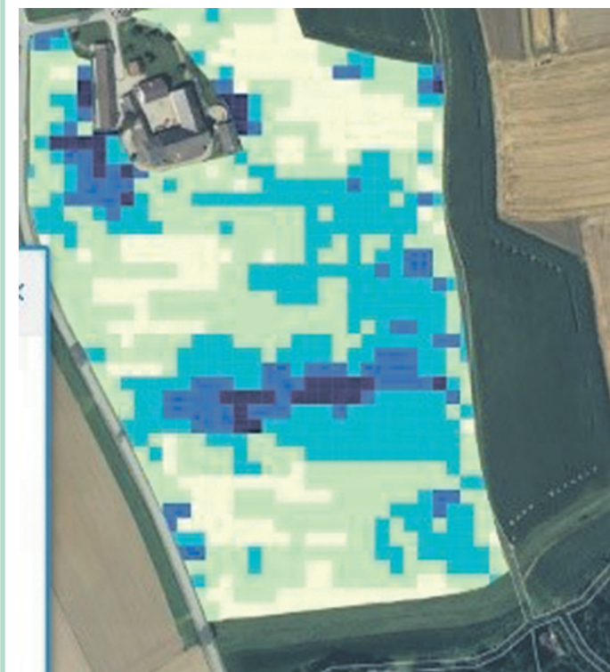
Abbildung 2: Die As-applied Karte der Düngemittel wird beim Online-Verfahren automatisch aus den Messergebnissen der Pflanzensensoren und dem eingespeisten Datenmaterial dokumentiert
