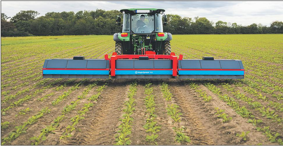
**Techniken wie der MagicSprayer erfordern noch einiges an Entwicklung, bis sie in der breiten Praxis eingesetzt werden können, im Bild der Prototyp des Geräts bei der Applikation in Zuckerrüben.**
