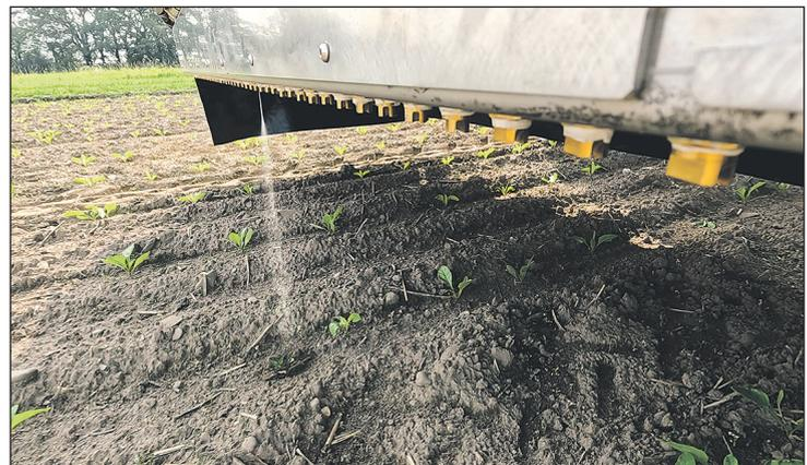
**Die punktuelle Applikation von Pflanzenschutzmitteln wird als Spot Spraying bezeichnet.**
