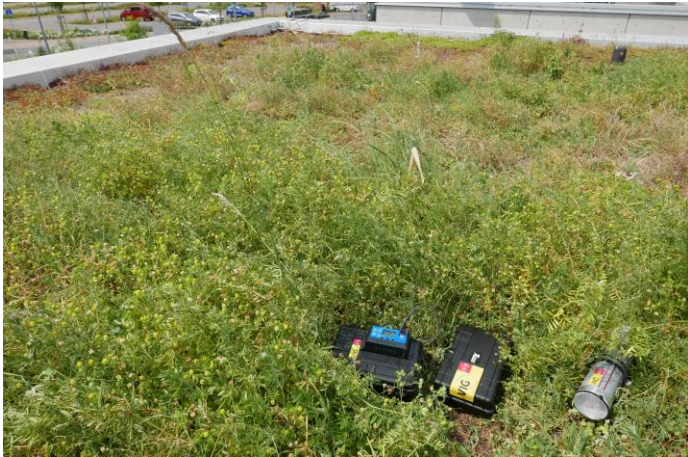
Feldversuch Uni Mainz: Staubfänger, Feinstaubsensor und Stromversorgung
