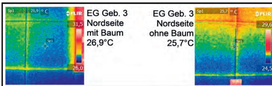
Thermografische Aufnahme der Gebäude 3, FH Bingen am 22.07.2013 um 13:25 Uhr, Lufttemperatur = 31,2 °C. © O. Panferov
